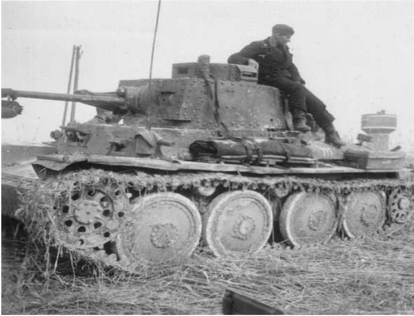
Маркировка 111 мелким шрифтом по крышке МТО, белая или желтая. Машина ранняя, Ausf.B. Укладка по левому борту нештатная – какой-то брезент большого размера, непонятный ящик сзади, кормовой Нотек торчит ближе к левому краю. Пушка возможно макет – несколько тоньше обычной и не зачехлена (хотя пулемет рядом – в брезенте). Установить место съемки и подразделение невозможно. Вероятно, место действия СССР, 8ТД
