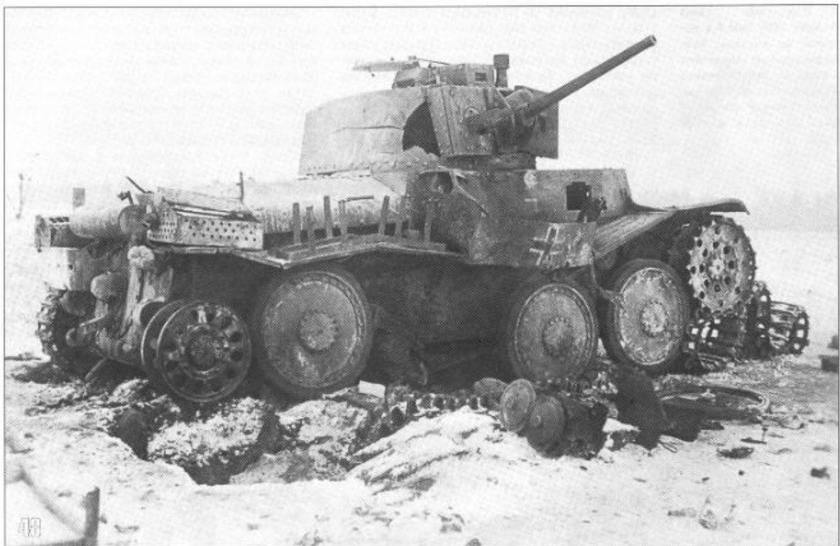
48. Танк Pz. Krfw 38(t) Ausf. F, уничтоженный огнем советской артиллерии у деревни Крюково. Декабрь 1941 года. Машина имеет зимний камуфляж, на задней стенке башни различим тактический номер 412 (МК).
