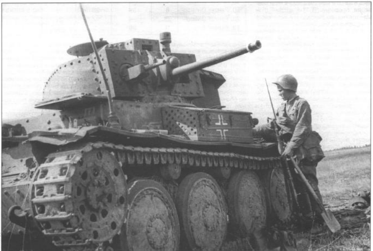
2с – фото Бронекolleкция Ausf. E/F (4 заклепки на башне)
